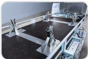
Nerezová nadstavba na prevoz ranených vrátane FERNO-nosítka
